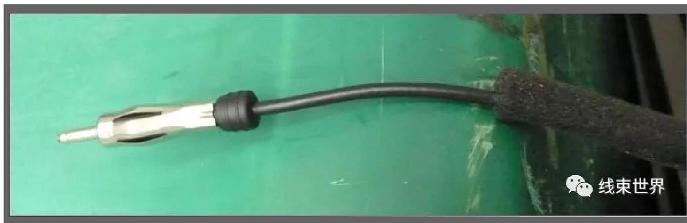
(1) 音响线束必须有防电磁干扰措施，确保音响系统等采集信号的信噪比，使之能够正常工作。
