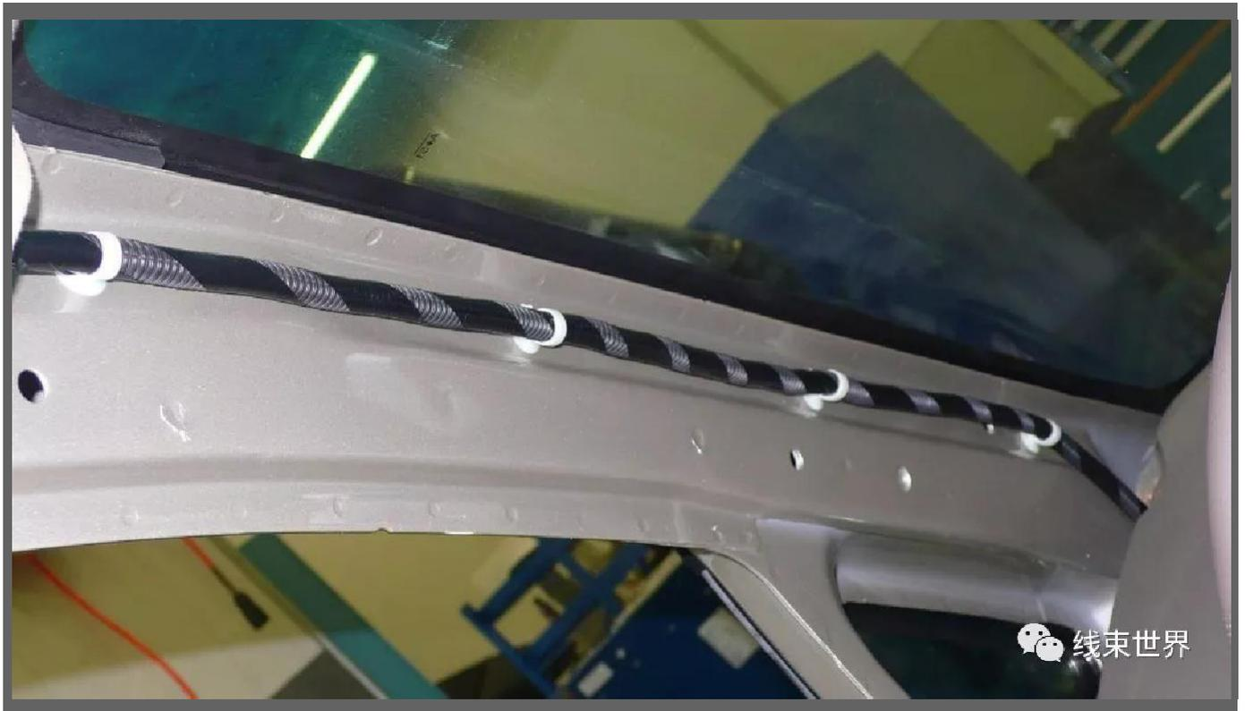
(1) 根据线束在整车上的实际安装位置，为了避免线束的低垂、移位，考虑线束的重量、固定方式和固定位置的方便性，线束必须有足够、合理的固定点和固定方式进行固定。
