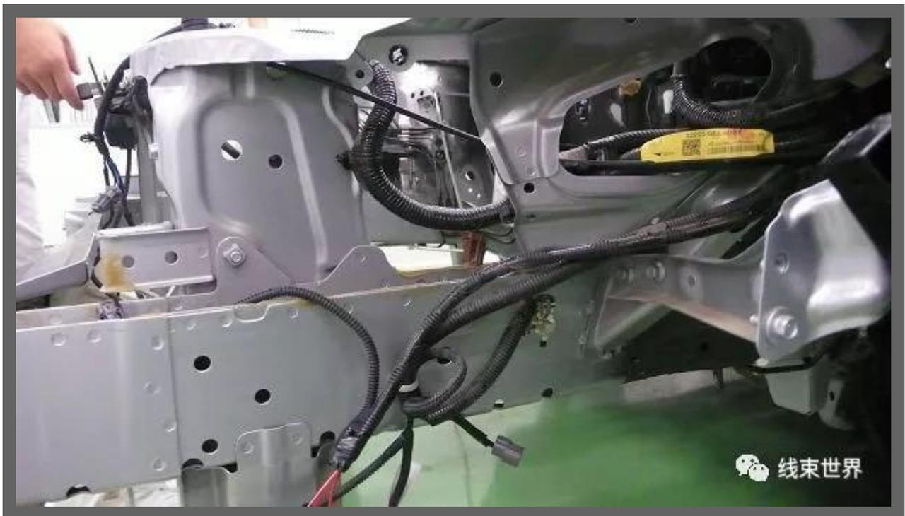
(1) 接地点布置在底盘或车身结构件上，即：布置在大一点的构件上，这样构件大、导电截面大、压降小，不会出现较大的、明显的接地点压差，影响回路内用电器的正常工作。
