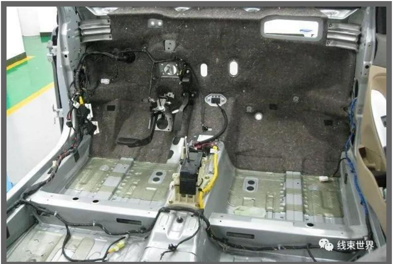
(1) 线束布置应沿边、沿槽（车身上设计的走线槽），避免线束直接承受压力。驾驶室内不得有线束外露；在可以观察到线束的位置，如：机舱部位，设置醒目的吸引点或醒目的颜色，在此安装的线束不突出、不显眼。
