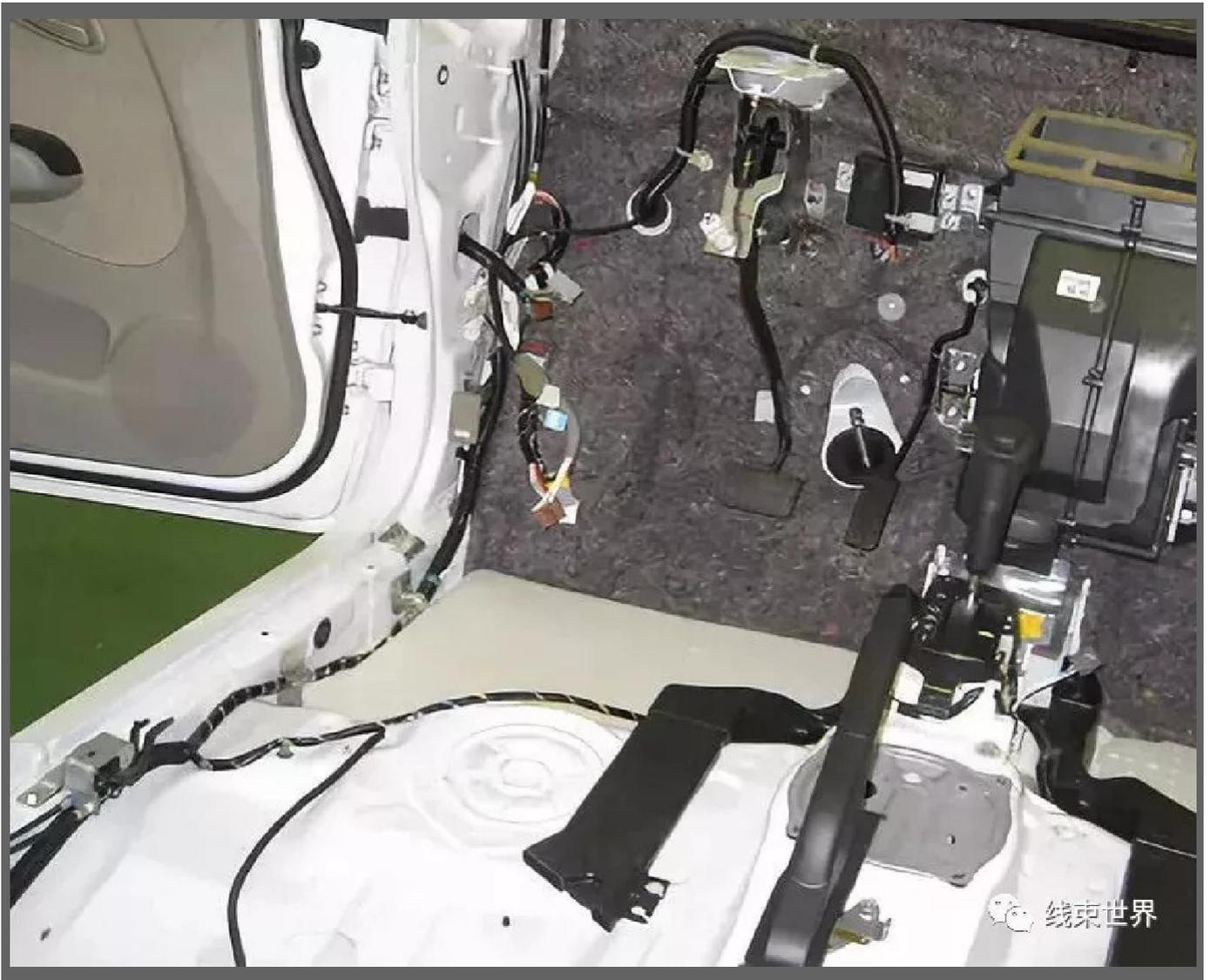
(1) 装配时不要把线束拉的太紧（尤其在横向布置线束），避免行驶车辆在颠簸状态下，引起线束固定点位置错动，导致两固定点之间距离瞬间增大，从而拉长线束造成线束内部接点拉脱/虚接、导线参数变化，甚至拉断导线。
