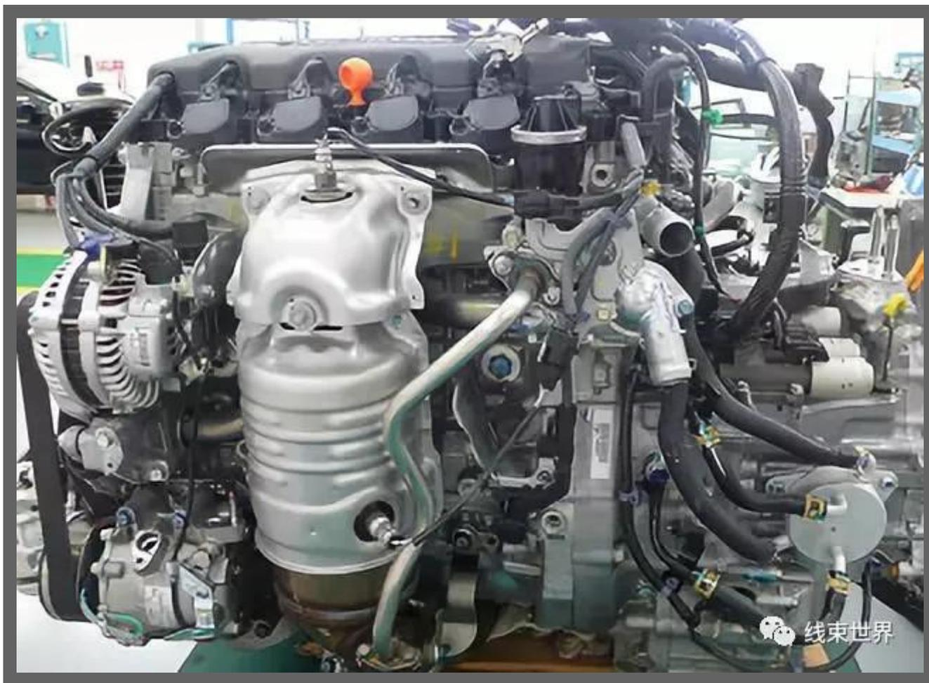
(7) 不与燃油管路、制动管路交叉或接触。尤其是在线束连接部位和油路连接部位，避免线路表面破损短路和油料蒸发密度等条件均达到一定条件时引起火灾。
