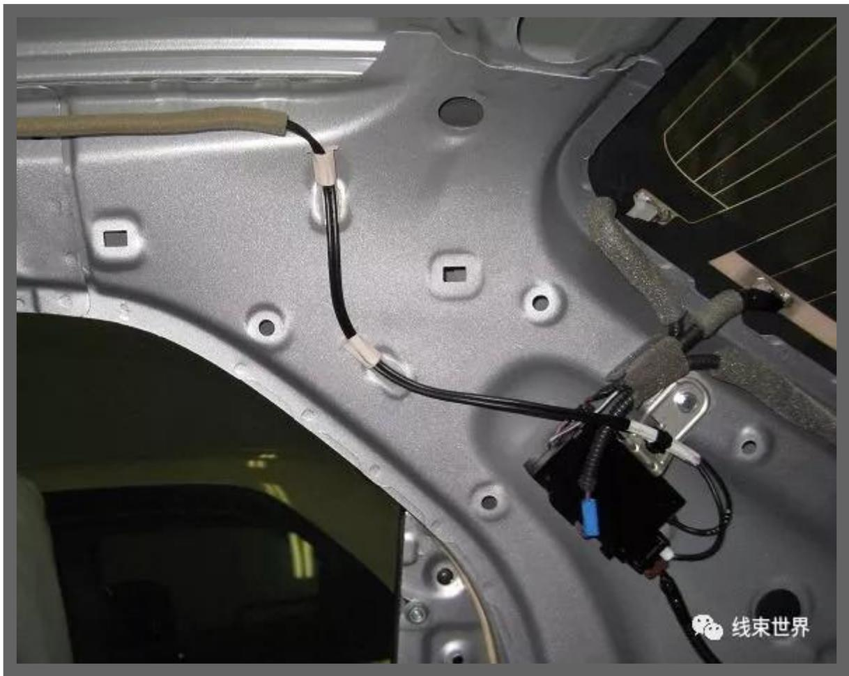
(3) 避开零部件电磁干扰源，如：将一些信号线的位置布置到尽可能离干扰源：电喇叭、点火线圈、电机类用电器等较远的位置。
