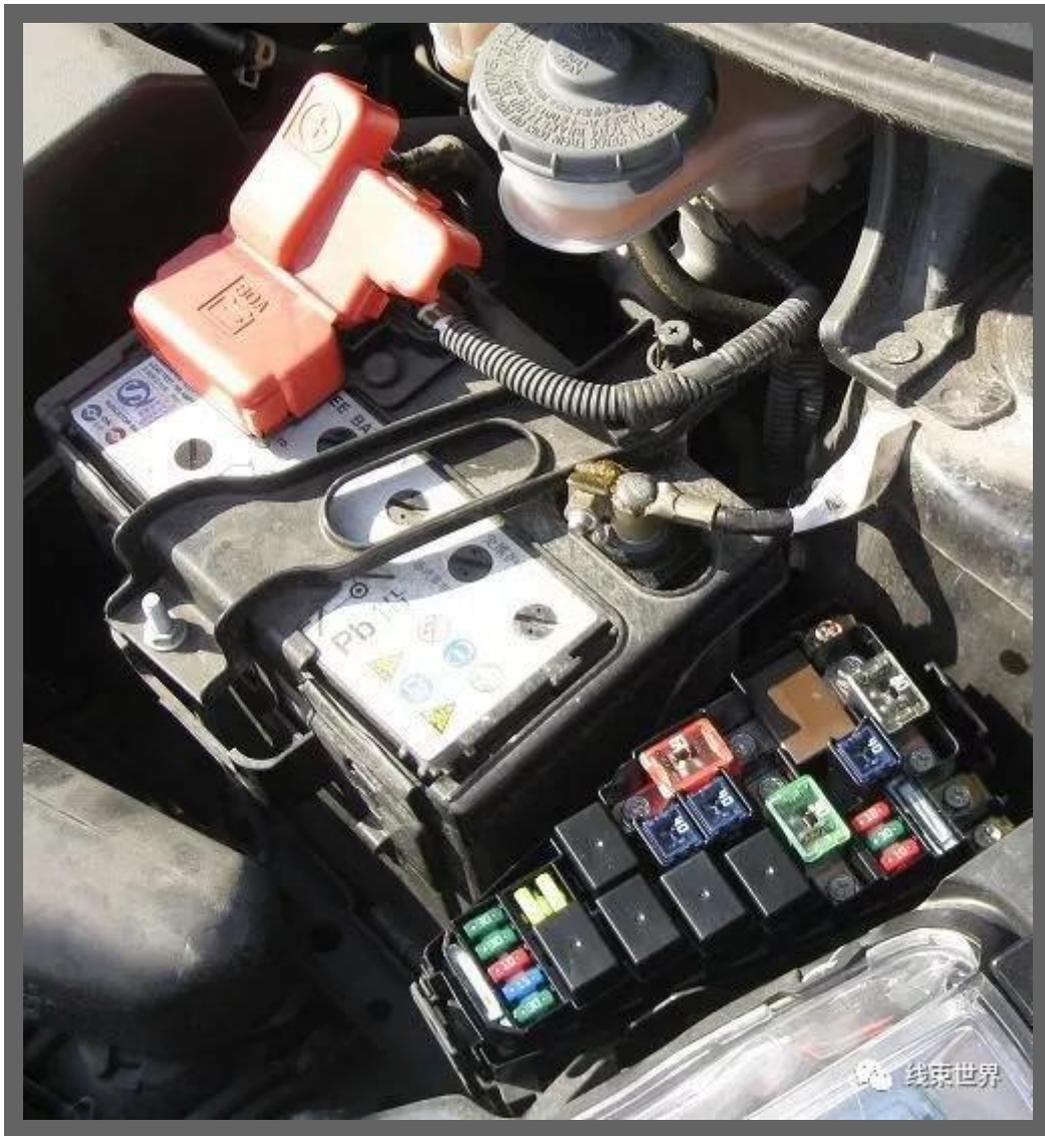
(1) 蓄电池正极端子和蓄电池盖板或发动机盖之间必须留有不小于20mm的间隙，避免短路，引起蓄电池瞬间大电流放电造成蓄电池爆炸。
