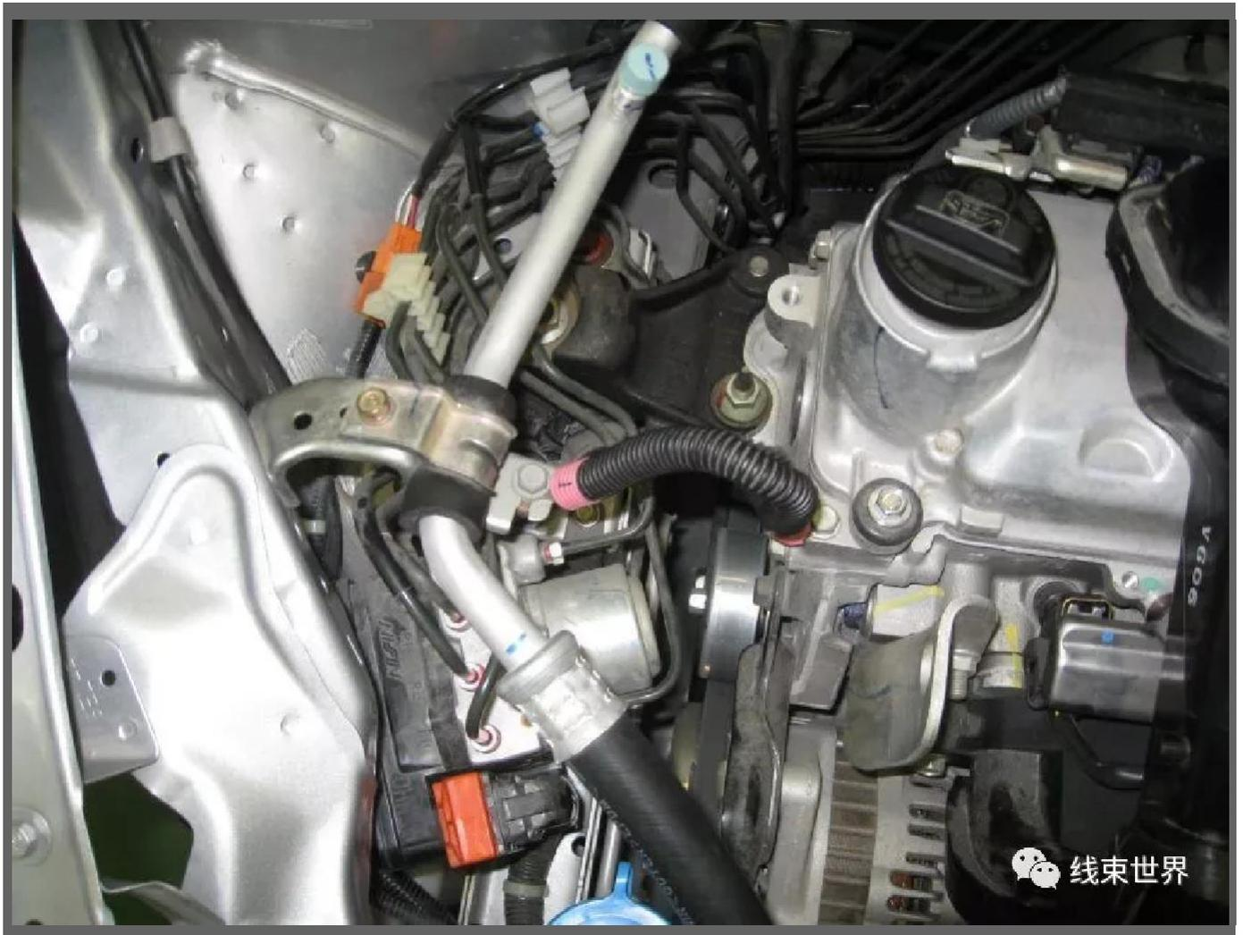
(2) 安装在振动或运动部件上时，应视实际情况预留长度。此预留长度根据部件振动幅度、运动件的最大运动行程确定。保证预留长度能够不使振动在线束上转递、
